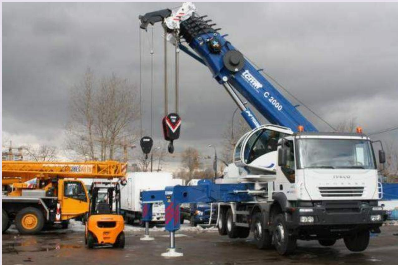
**Машинист автомобильного крана** (крановщик) – подъезжает на автокране на место работы. Решает где установить его, учитывая силу и направление ветра, наклон рельефа. С помощью грузчиков производит погрузку, выгрузку и перемещение различных грузов. Следит за исправностью автокрана. Производит его ремонт в случае поломки.
